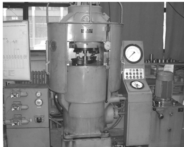
Fig. 3. - 6.3 MN hydraulic press, Sack und Kiesselbach
